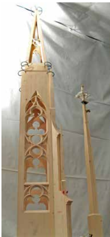
Zusammengesetztes Turmelement mit ersten Strebepfeilern und Fialenmodell
