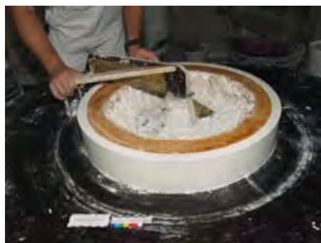
◀ Drehen der Basis als Ring mittels einer Radius-schablone
