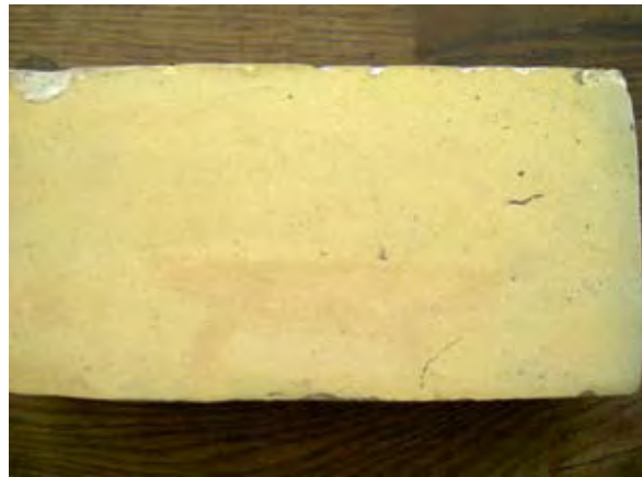
◀ Schliffbild eines Birkenwerder Ziegels Typ II mit sehr homogenem Gefüge
